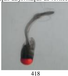
Figura 3. Visualização da formação de vórtices do tipo “hair pin”
